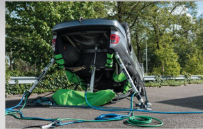
ProXif Max можно использовать вместе с гидроцилиндром, такая конструкция обладает грузоподъемностью в 10 тонн.
