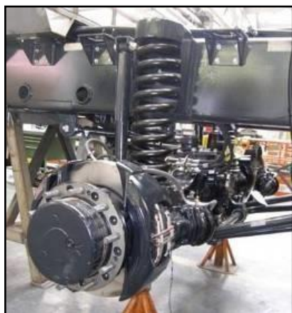
Жесткие мосты с независимой пружинной подвеской и дисковыми тормозами
