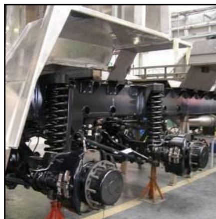
Жесткие мосты с независимой пружинной подвеской и дисковыми тормозами
